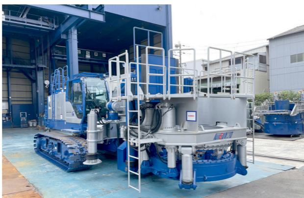
低空頭大口径鋼管杭回転圧入機 FG-150N 2021年7月導入
